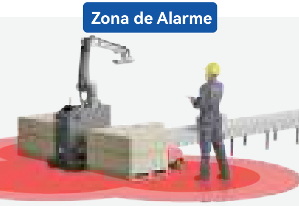
Aciona a paragem imediata do robô para evitar colisões diretas entre pessoas e robôs.
