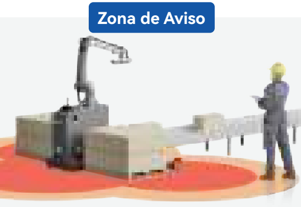
O robô funciona a velocidade reduzida, criando a margem necessária para evitar emergências.
