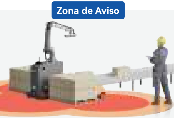
O robô funciona a velocidade reduzida, criando a margem necessária para evitar emergências.
