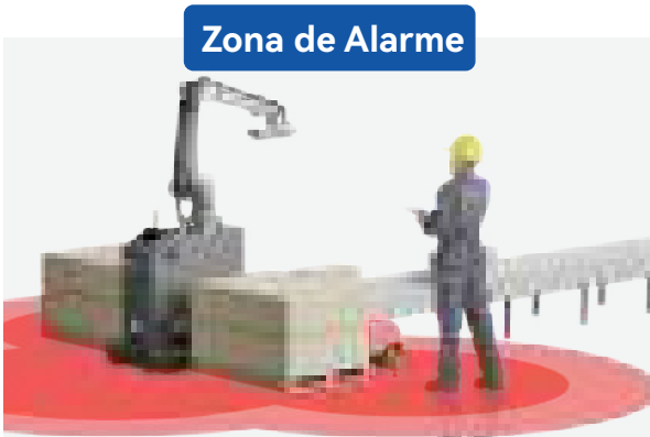
Aciona a paragem imediata do robô para evitar colisões diretas entre pessoas e robôs.
