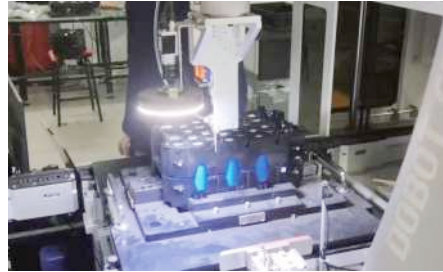
Aperto de Parafusos de Baterias de Energia
