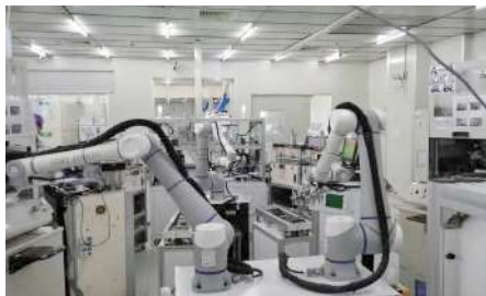
Carregamento e Descarregamento de Placas PCB
