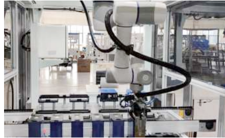
Carregamento e Descarregamento para Inspeção de Baterias
